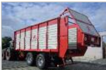
nabudowa ze ścianą przesuwaną
